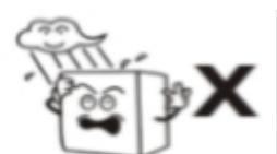
Категорически не рекомендуется устанавливать холодильную витрину на площадке, находящейся под воздействием солнечного света, или же вблизи любого источника тепла. В противном случае неизбежно снижение производительности холодильной системы
