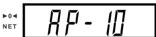
□ При выключенном дисплее нажмите и отпустите клавишу **ON/OFF**, затем сразу нажмите клавишу **ZERO** и удерживайте ее до тех пор, пока на дисплее не появится признак состояния функции автоматического отключения (предыдущее установленное значение), например <AP-10>. Цифра «10» означает время в минутах в течение которого не должно производиться никаких операций с весами для того, чтобы произошло автоматическое отключение.
