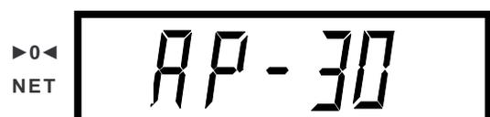
□ Если требуется изменить установленное значение, нажимайте клавишу **TARE** до тех пор, пока на дисплее не высветится нужное значение работы функции автоматического отключения, например <AP-30>. Если необходимо отключить функцию автоматического отключения, установите <AP-00>.
