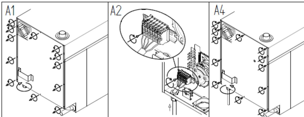
Неправильное соединение может привести к перегреву клеммной колодки, что грозит взрывом и поражением электрическим током.
